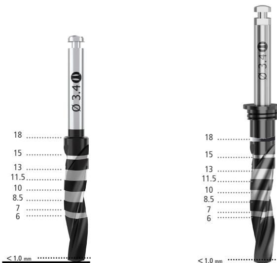
La extracción de hueso cortical con Dense Drill debe realizarse a muy baja rotación (15 - 50 rpm), sin irrigación. Las Dense Drills también se pueden considerar para preparar gradualmente los sitios quirúrgicos, la regularización ósea, la ampliación de la región cortical y en los sitios posteriores a la extracción, para evitar la compresión del hueso cortical o la desviación de la posición del Implante durante la inserción.
